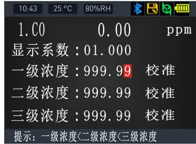
通入标准气体或被测气体，将光标移到“校准”位置，再按“⓪”键校准，如果成功则出现“成功”字样，如果不成功则出现“失败”字样，如右图及下图：
