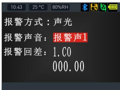
**报警回差**：即报警回程差，可设置每一通道的报警回差值，如果设置为0，只要数值达到报警设定值就马上报警，若不想数值在报警设定值的临界点发生频繁报警，可以把报警回差设置一定的数值，通过“①”键和“《《”键和“》》”键修改，如右图：
