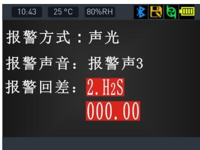
**报警模式**：一般不需要设置，已默认设置好。O2和N2默认设置为 <AL>AH报警，其它气体默认设置为 >AL>AH报警，可以修改或设置为“关闭报警”（备注，若选择关闭报警，则测量浓度值高于报警值时，将不产生报警），如右图：
