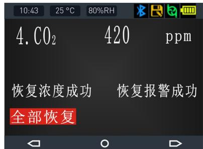
当设置错误或测试浓度不准确时需要进行恢复出厂的操作，如果是人为因素造成的不良可以得到恢复，可以恢复出厂的参数：零点校准值、浓度校准值、报警值、报警方式、报警模式、最大量程等。
