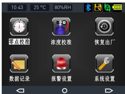
选择要校准的通道，按“①”键进行零点校准，如下图：
